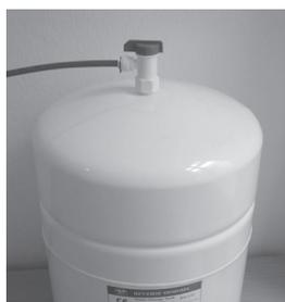
**Bitte beachten Sie:** Das Luftventil seitlich oder unten am Tank dient der Druckluftregulierung. Der Luftdruck ist voreingestellt auf 0,5 bar bei leerem Tank. Es handelt sich um ein Autoventil, das sich geschützt unter einer Abdeckung befindet. Kontrollieren Sie den Tankdruck regelmäßig beim Filterwechsel.
